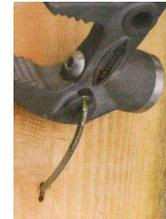
頭部の釘抜きは180度回転が可能で、釘が容易に抜き取れる構造(特許取得済)
