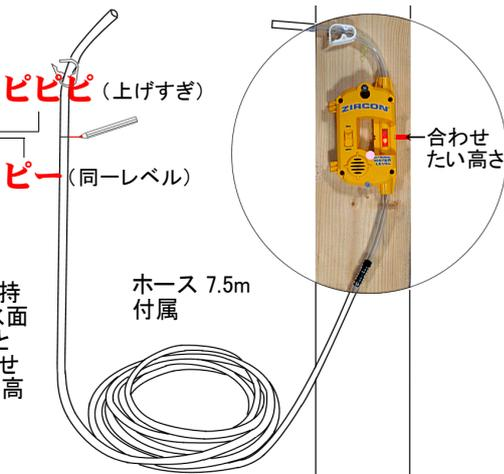
水を入れたホースの端を持ち上げていくと、両端の水面が徐々に上がり、「ピー」と音がしたポイントが「合わせたい高さ」と同一レベルの高さです。(誤差 +1.6mm)
